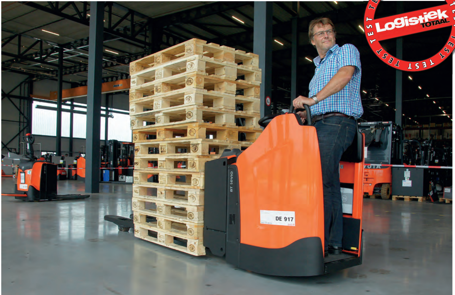
De Levio P-serie van BT is leverbaar van 2 tot en met 2,5 ton draagvermogen en in zowel meeloopuitvoering als met vaste zij- of achterschotten
